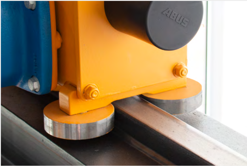
Detección de obstáculos en el testero inferior de serie y no es necesario un rail guía en el suelo.
